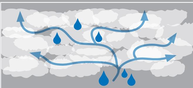
Speziell beim Extrudieren entsteht eine Mikro-Drainage und eine raue Haftoberfläche. Diese Eigenschaften bleiben für die gesamte Lebensdauer der Fliese erhalten.
